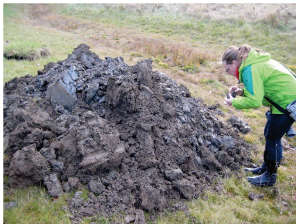
Figur 32. Uppgrävt material från provgropen mellan hål 14 och 15. Hedlund studerar aggregatstrukturen.
